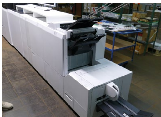
Die integrierte Broschürenfertigung inklusive Drei-Seiten-Beschnitt, Rilleinheit und Square-Back-Rückenpressung.
